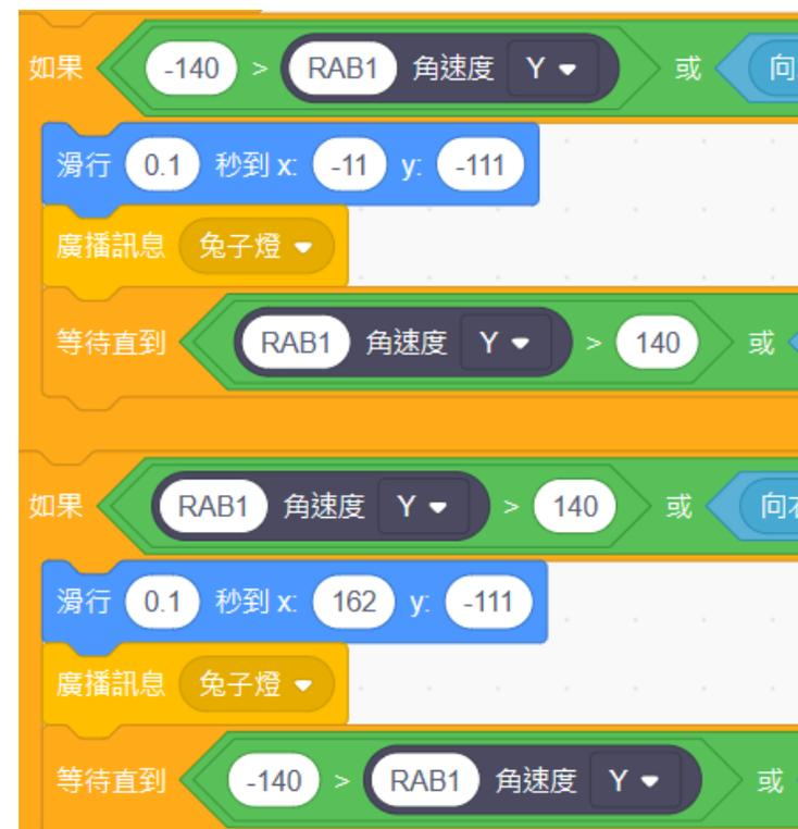
在磁生電小遊戲中，我們運用了角速度Y，讓磁鐵左右移動
